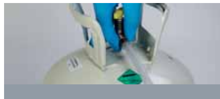
Abb. 11: Anbringen des Materialschlauches an das Zylinderanschlussventil
