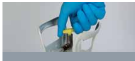
Abb. 14: Langsames Öffnen des Zylinderanschlussventils.
