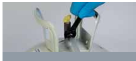
Abb. 12: Festschrauben des Schlauches.
